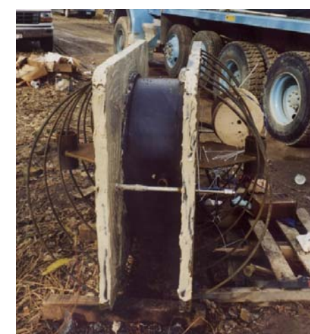
Cilindro spaccato in una prova di modulo laterale della roccia con O-cell.
